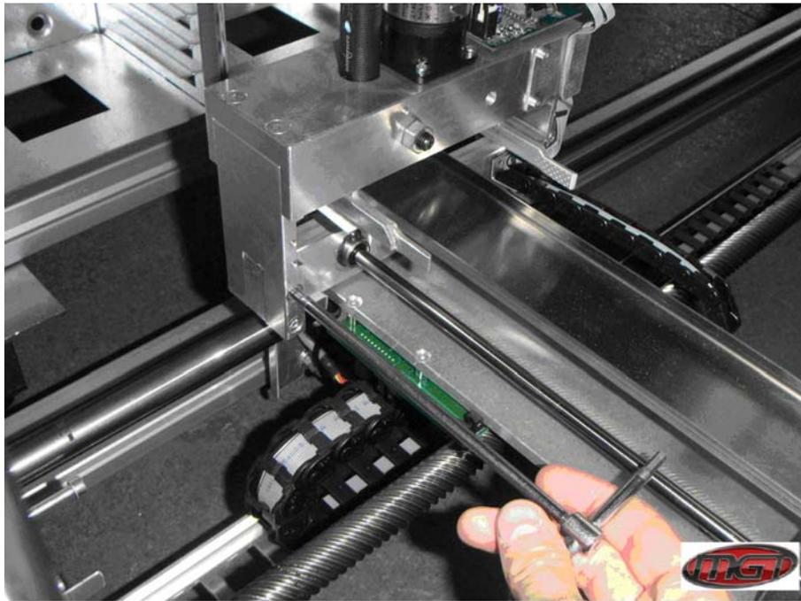
2) Una volta smontato il blocco pinza, scollegare i 2 connettori del motore e del sensore dalla scheda elettronica sopra-pinza
