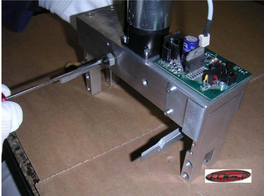
10) Bloccare il grano stringendo con il relativo dado, inserire il cavo motore e il cavo sensore nella scheda sopra-pinza
