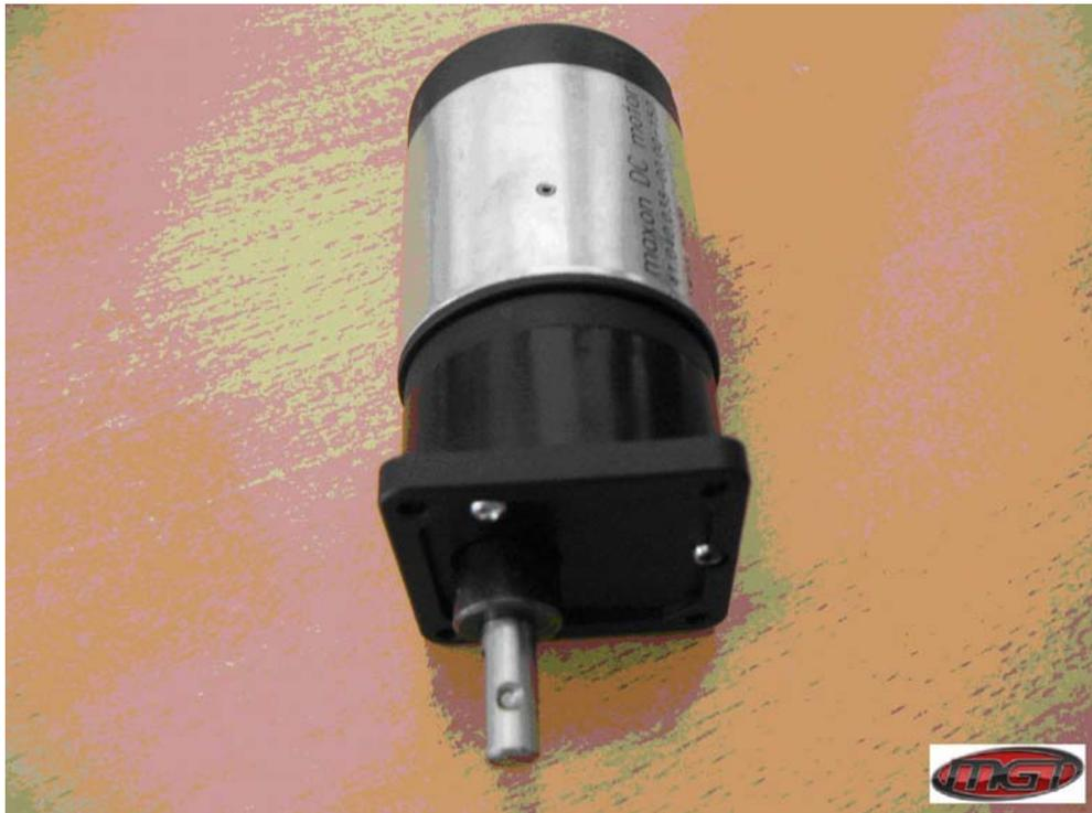
7) inserire il nuovo motore sempre a pinza rovesciata e manine completamente aperte, vedi immagine al punto 5. Controllare anche la lubrificazione delle 2 cremagliere. I denti delle cremagliere devono essere ricoperti da un velo di grasso, il grasso in eccesso viene espulso dalle cremagliere con il movimento, se ci sono pezzetti di grasso in eccesso accumulato, rimuoverli con della carta assorbente.
