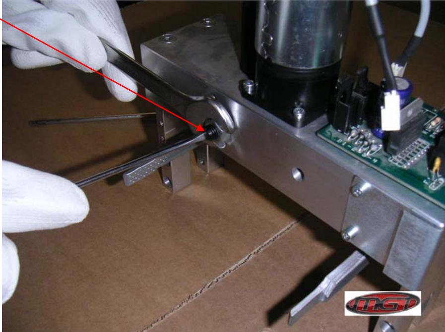
4) Svitare le 4 viti di fissaggio del motore
