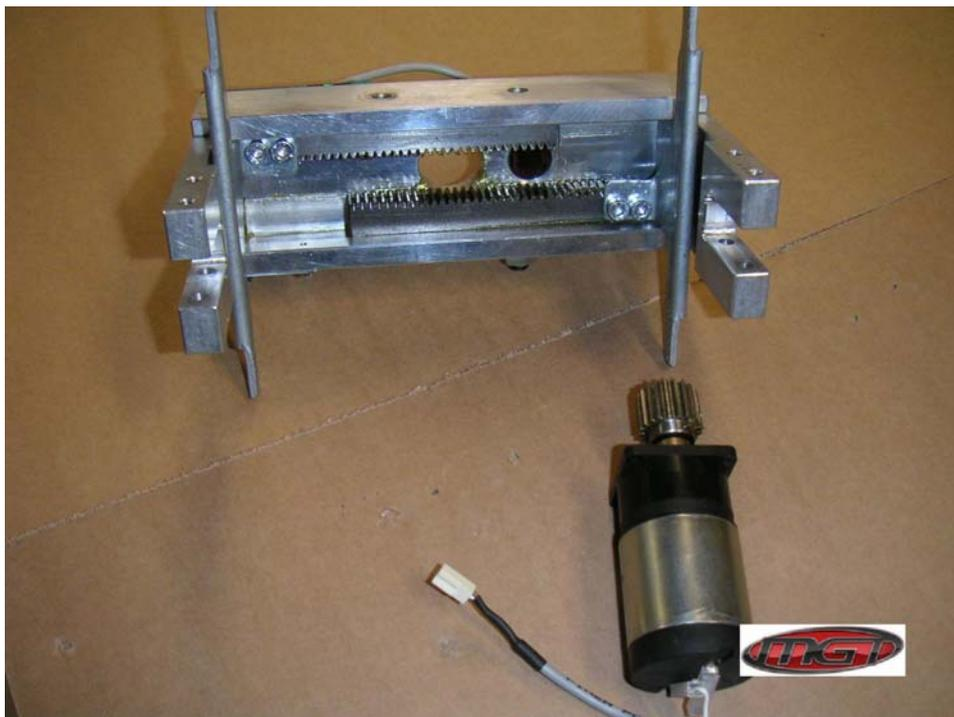
6) Si deve montare il pignone del vecchio motore sul nuovo motore, in quanto questo pignone si è già adattato nel corso del tempo alle cremagliere della pinza. Il nuovo pignone montato sul nuovo motore dovrebbe ri-adattarsi alla cremagliera, cosa per la quale è necessario del tempo. Per smontare il pignone dal nuovo motore ci sono 2 grani da svitare, con chiave a brugola da 2, vedi foto sottostante.
